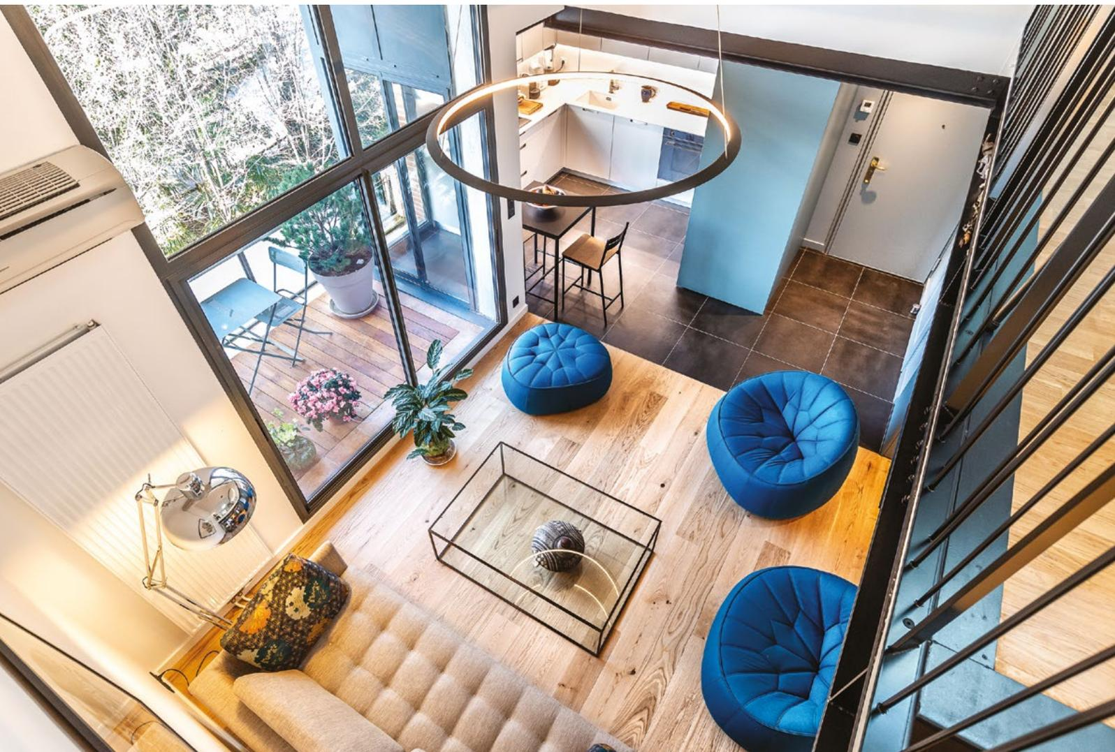
*Remise à niveau des sols des différents espaces. Le sol de l'entrée et la cuisine est revêtu d'un sous carreau acoustique puis d'un carrelage de chez [La Matériauthèque de Catherine](#) (Escalquens). Le sol de la pièce à vivre est recouvert d'un parquet contrecollé en chêne Haro de chez [La Matériauthèque de Catherine](#) posé par [L'Art du Bois](#) (Drémil-Lafage).*
