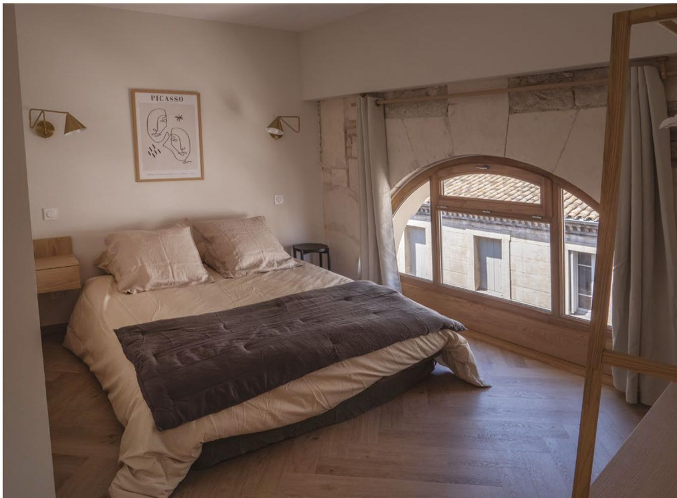
*Dans cette chambre, on ressent l'importance patrimoniale du lieu. L'entreprise MA2P de Patrick Piquemil à Castres a remplacé les anciennes fenêtres par un modèle en bois avec soubassement, côté chambre et côté pièce à vivre. Au-dessus, le mur en pierre est isolé et doublé d'un placo. Ce dernier intègre un bandeau Led qui diffuse une lumière scénique sur la pierre.*
