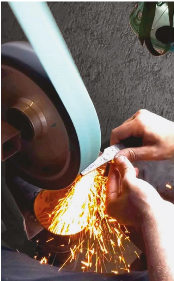
Étape après la forge du détourage de la soie du couteau.
