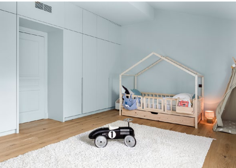
Pays de cocagne. Chambre d'enfant bleu pastel. La cloison séparative avec la coursive (à gauche sur la photo) supporte tous les rangements, ainsi que la bouche de soufflage de la climatisation au-dessus de la porte. Si les portes de placards sont lisses et modernes, la porte de la pièce est quant à elle au motif classique, référence à l'ancien.
