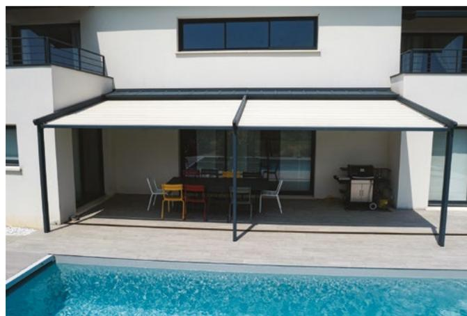
*La pergola à toile rétractable mesure 8x3,60m. La toile est en polyester enduit de PVC.*
