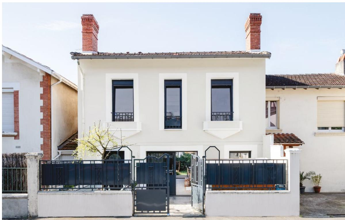
*Garde-corps, clôtures et portail ont été réalisés par un ferronnier sur le modèle de ceux d'origine. La façade a été rénovée, couleur sable, avec les encadrements blancs. Menuiseries en aluminium avec coffres des volets roulants en linteau à l'intérieur. À l'étage, l'ancienne porte d'entrée à laquelle on accédait par un escalier, a laissé place à une porte-fenêtre. L'accès se fait à présent par le rez-de-chaussée.*
